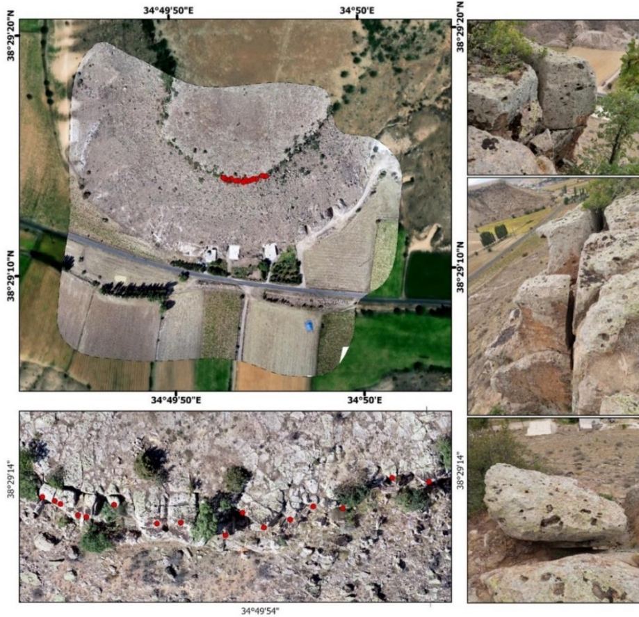
Şekil 7: Çalışma sahasında düşme olasılığına sahip kaya bloklarına ait konumlar ve kaya bloklarından örnekler
