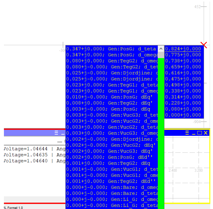
Slika 9. Lista nestabilnih polova nakon eliminacije pola izazvanog generatorom u MHE „Darkovce“
