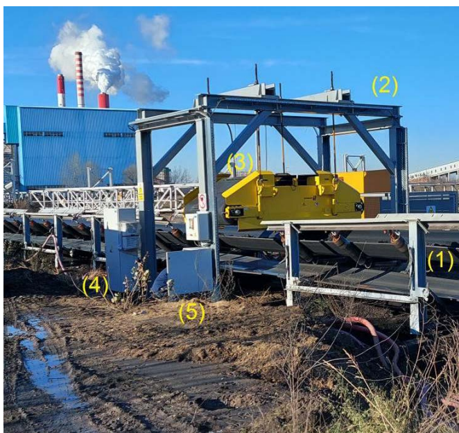
Slika 10. Prikaz dispozicije podstanice elektromagnetnog separatora
