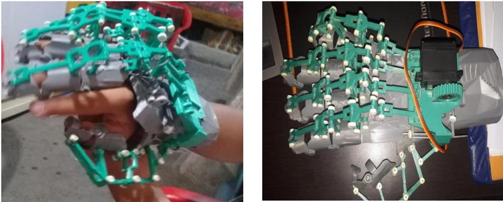
**Figura 2.** Exoesqueleto con tecnología para la rehabilitación de la mano.
