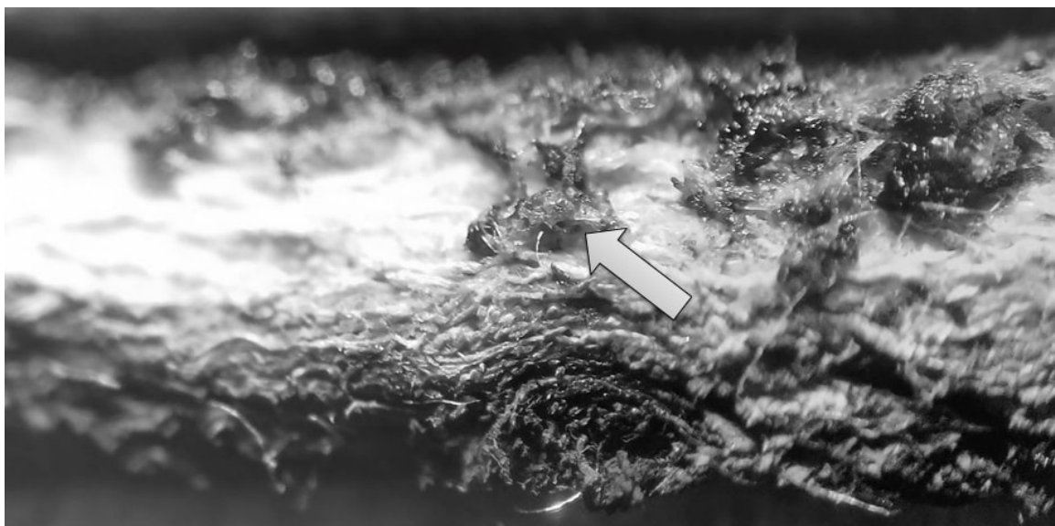
Рисунок 6 – Микроскопия образца в месте воздействия выплеска 96%-й H_2SO_4
