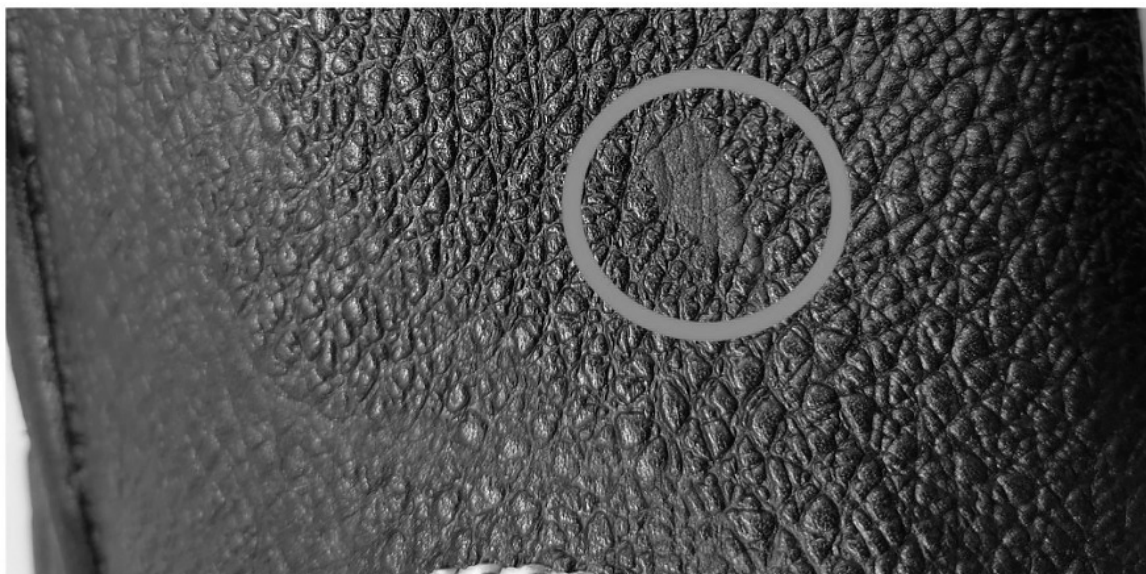
Рисунок 4 – Оценка результатов после испытаний на выплеск сапог (образец 1) 20%-й H_2SO_4
