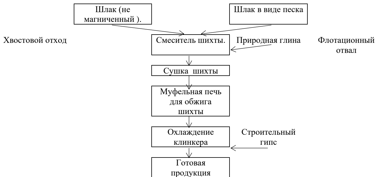
Рисунок. Технологическая схема получения портландцемента из техногенных отходов КСК в лабораторных условиях.
