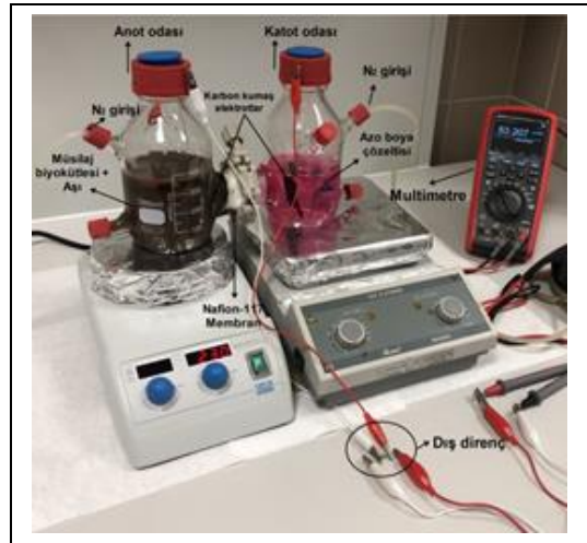
Şekil 2. MYH deneysel düzenek. Figure 2. MFC experimental setup.
