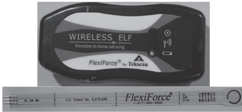
รูปที่ 3: ตัววัดแรง (WELF system transmitter และ flexiforce sensor (Tekscan, USA))
