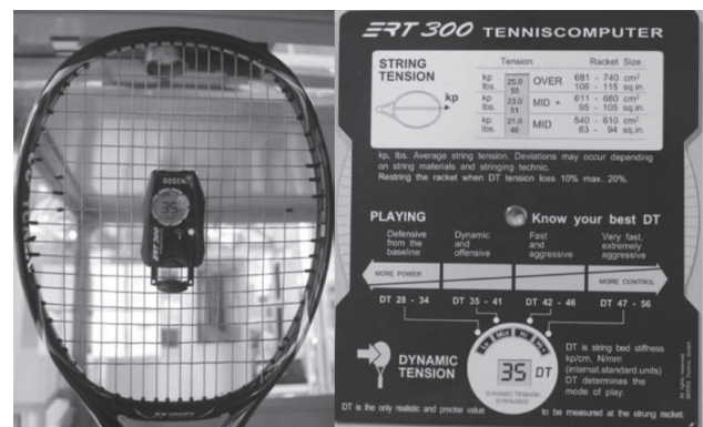
รูปที่ 1: การวัดความตึงเอ็นหน้าไม้เทนนิส
