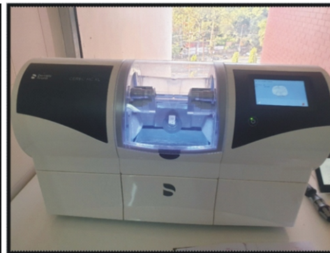
Fig. 6 CEREC MC XL Milling Unit
