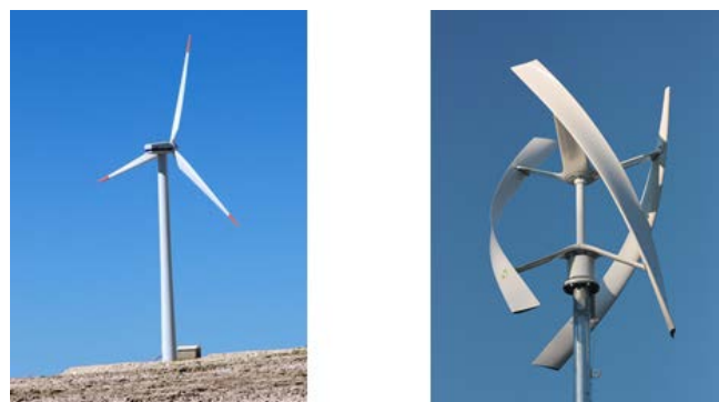
Slika 1. Primeri horizontalnog (levo) i vertikalnog (desno) vetrogeneratora 1
