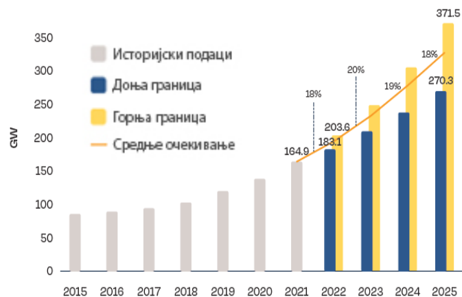
Slika 2. Istorijski i očekivani kapaciteti fotonaponskih elektrana u EU
