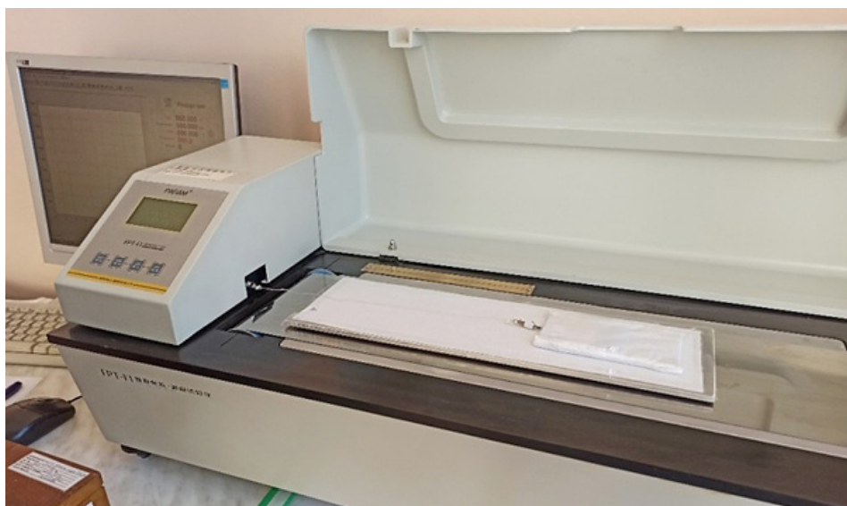
Рисунок 7 – Определение коэффициента тангенциального сопротивления тканей на приборе FPT-F1
