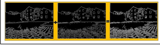
Şekil 3. Canny ve LoG kenar algılama tekniklerinin birlikte kullanımı.
