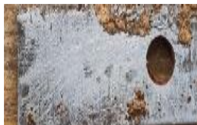
Рисунок 1б. Фотография образца металла в присутствии ингибитора.
