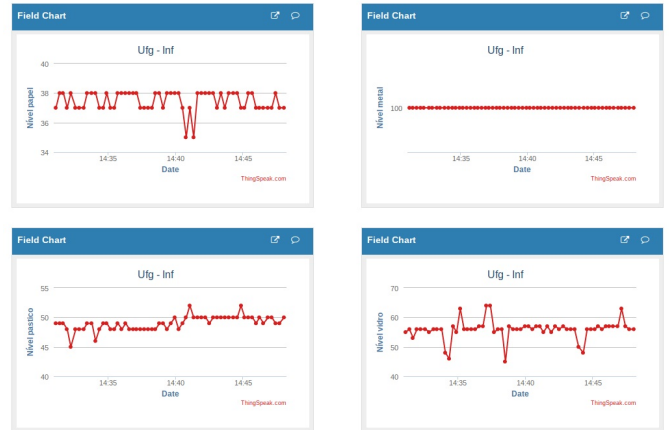
Fig. 23. Gráficos exibindo a variação nos níveis de lixo da lixeira seletiva com os dados enviados pelo sensor ultrassônico instalado na parte superior das lixeiras.
