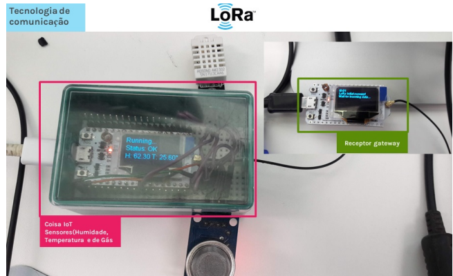
Fig. 17. Sensor de umidade, temperatura e gás da Biblioteca Central - Campus Samambaia
