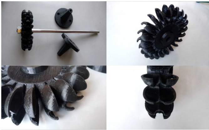
Slika 6. Izgled mlaznika i radnog kola nakon izrade na 3D štampaču
