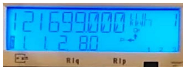
Slika 3. Ekran brojila A , sa slike 2.a), klase tačnosti 0,2 S, na kome je prikazana trenutna vrednost ukupne aktivne električne energije za povratni smer energije sa rezolucijom pokazivanja energije na tri decimalna mesta u kilovatčasovima.
