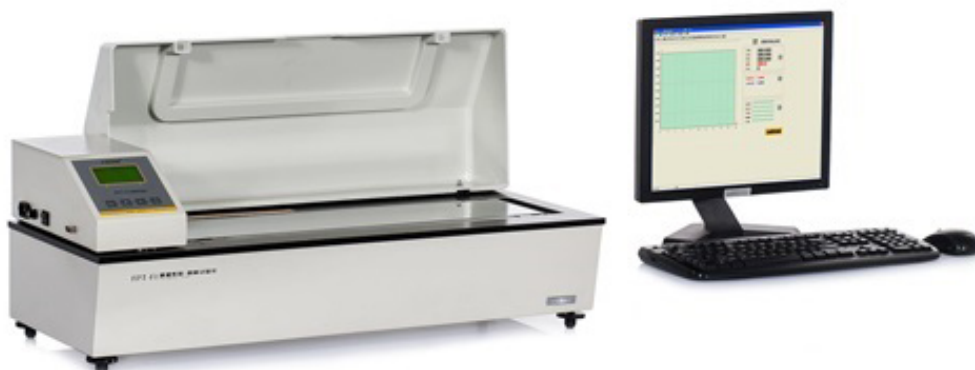
Рисунок 2 – Внешний вид прибора PARAM FPT-F1: 1 – панель для закрепления опорной поверхности; 2 – электронный динамометр; 3 – монитор
