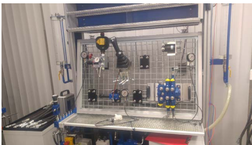
Rys. 6. Komponenty hydrauliki mobilnej – systemy sterowania typu LUDV
