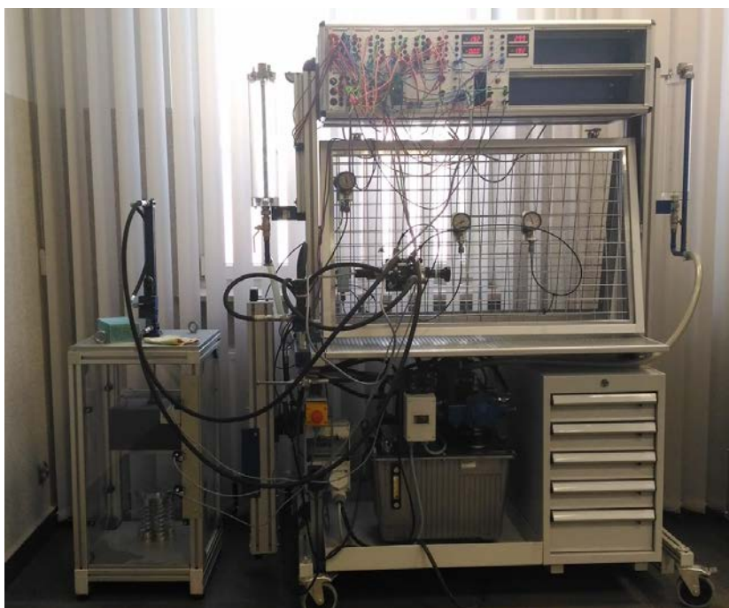
Rys. 2. Automatyczna prasa hydrauliczna z możliwością doboru parametrów cyklu roboczego
