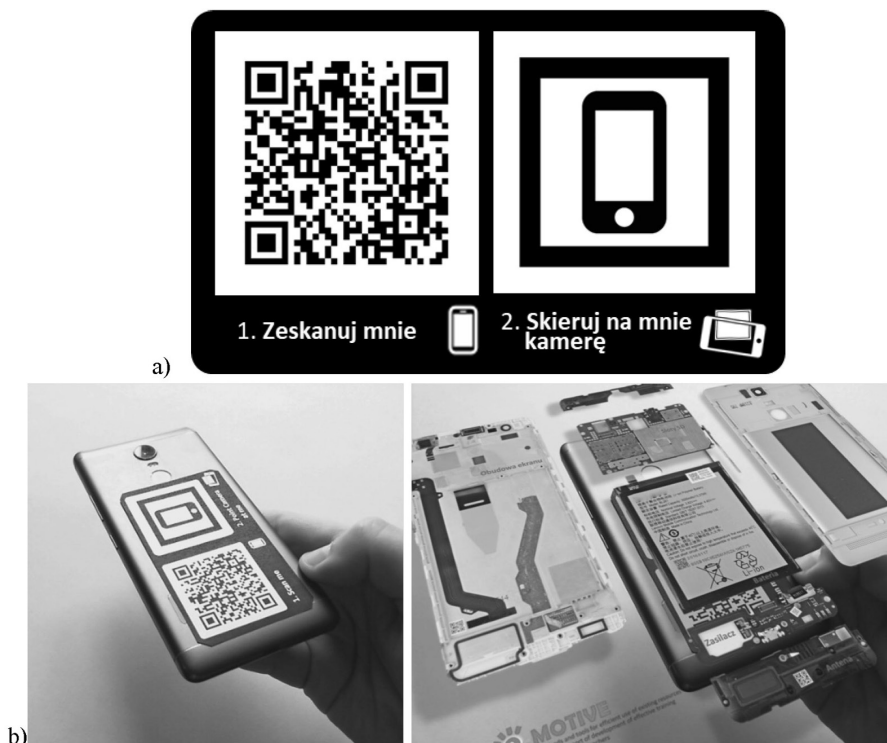
Rys. 4.3. Materiał szkoleniowy opracowany w e-MOTIVE AR: a) QR code (po lewej) i marker (po prawej), b) obiekt z przyklejonym QR code i markerem (po lewej) oraz widok obiektu z nałożoną informacją o jego wewnętrznej budowie (po prawej)
