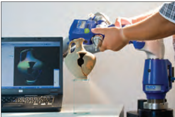
Figure 53. Laser scanning for www.carnuntum-db.at : grid of the scanned object (2016). (Amt der NÖ Landesregierung-Abt. Hydrologie und Geoinformation, St. Pölten).
