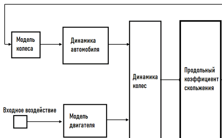
Рисунок 4. Продольная математическая модель в среде Matlab Simulink
