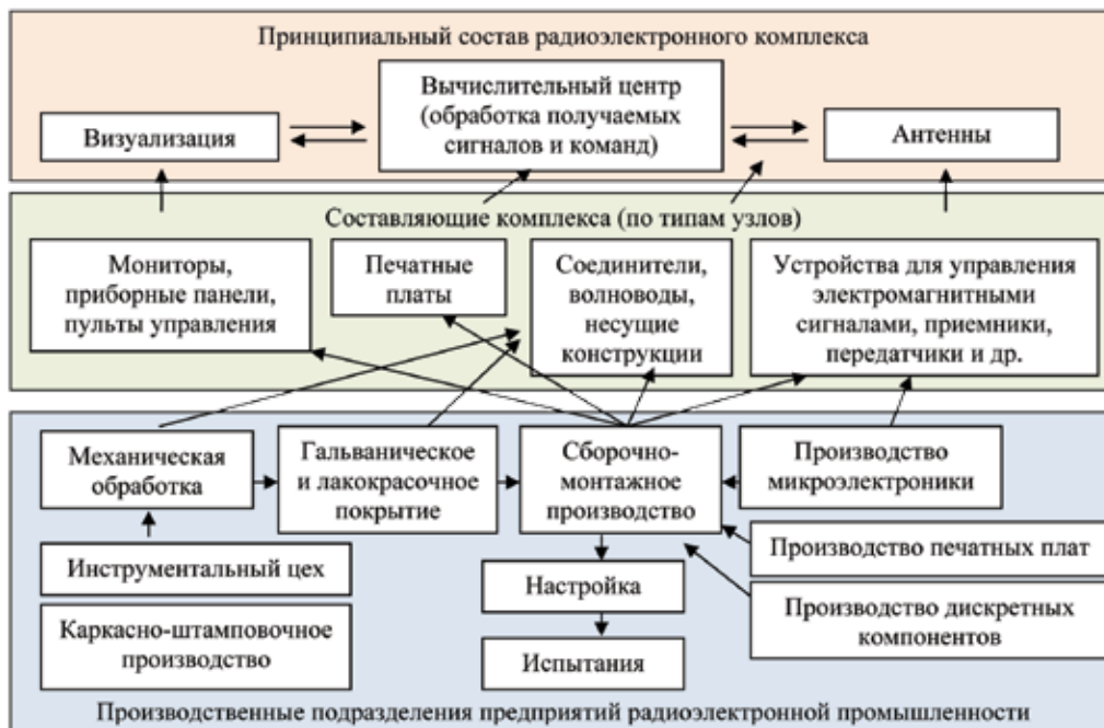
Рис. 1. Схема состава продукции радиоэлектронной промышленности во взаимосвязи с производственными процессами
