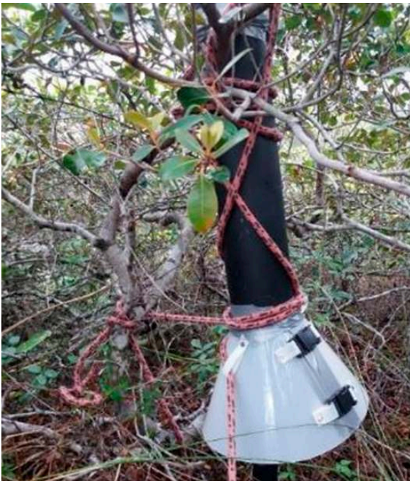
Figura 10. Equipamento de aquisição instalado na vegetação da Restinga do Foguete, com o microfone voltado para baixo
