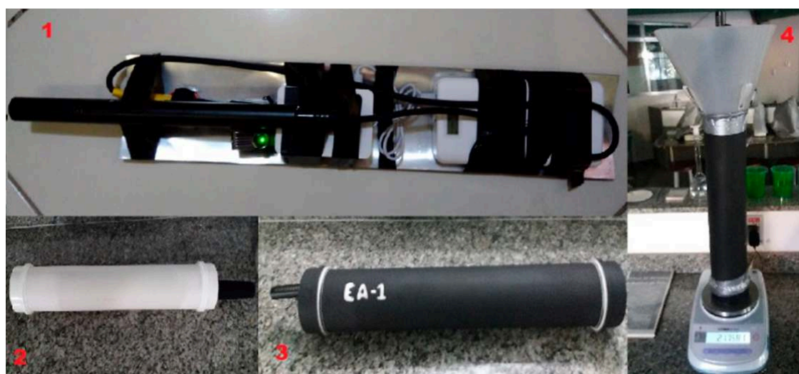
Figura 7. Fases de montagem do EA-1. 1 – Fixação dos componentes do equipamento; 2 – Componentes inseridos no cano PVC; 3 – Pintura/camuflagem do EA-1; 4 – Equipamento finalizado com colar elisabetano, em pesagem
