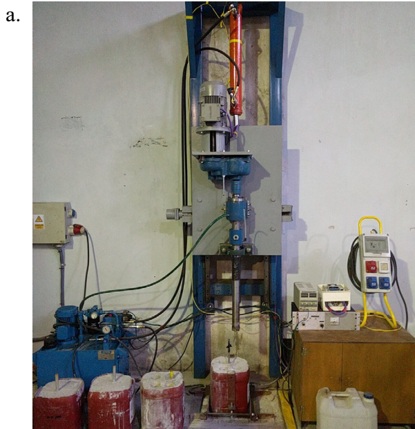
Figura 1. a. Sistema completo de perforación con control de velocidad, central hidráulica, y herramienta de perforación. b. Detalle de la broca con cuerpo realizado en SAE 4140, dos filos de carburo de tungsteno y salidas de fluido.
