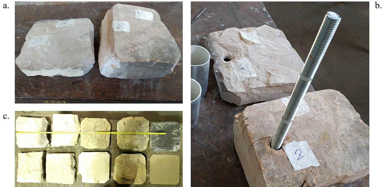
Figura 3. a. Dos tipos diferentes de estratos con variación apreciable de espesor. b. Estratos con perforación para guía de ondas colocada. c. Diferentes estratos utilizados para ensamblar las probetas (arenisca, caliza y pizarra) y su tallado para montaje dentro de cada probeta
