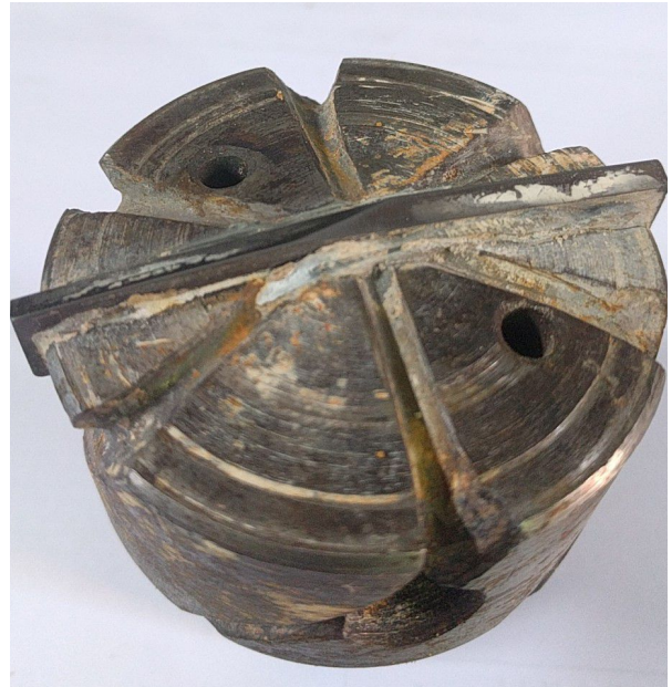
Figura 1. a. Sistema completo de perforación con control de velocidad, central hidráulica, y herramienta de perforación. b. Detalle de la broca con cuerpo realizado en SAE 4140, dos filos de carburo de tungsteno y salidas de fluido.
