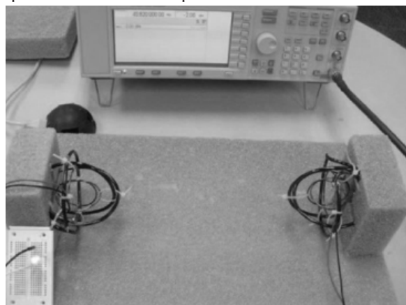
Figura 3. Implementación de sistema con antenas 3D-Loop [3].
