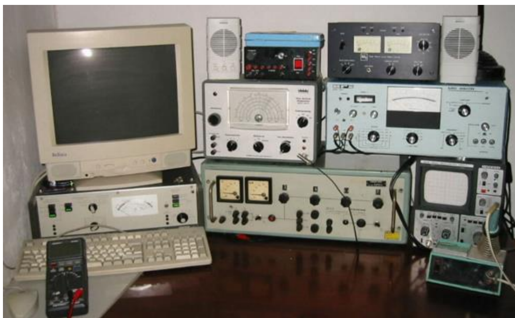
Рис. 2. Пример расположения псофометра в радиотехническом/радиолюбительском комплексе электроакустического оборудования (простейшем метрологическом стенде)
