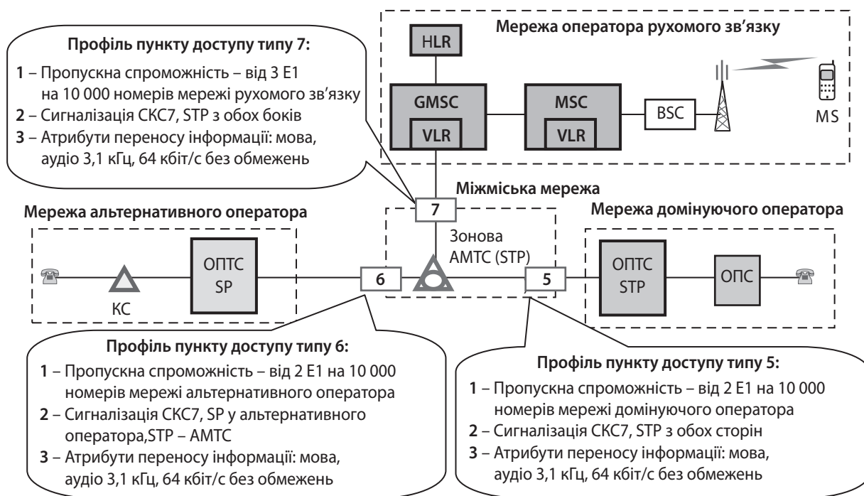
Рис. 8. Еталонна модель реалізації послуг доступу до телефонних мереж операторів зв'язку при наданні послуг рухомого зв'язку
