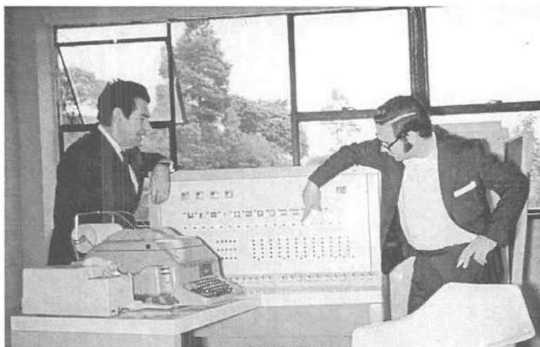
Foto #1: Se aprecian el teleimpresor y su sistema adjunto de perforación y alimentación de cinta de papel, y el panel principal.
