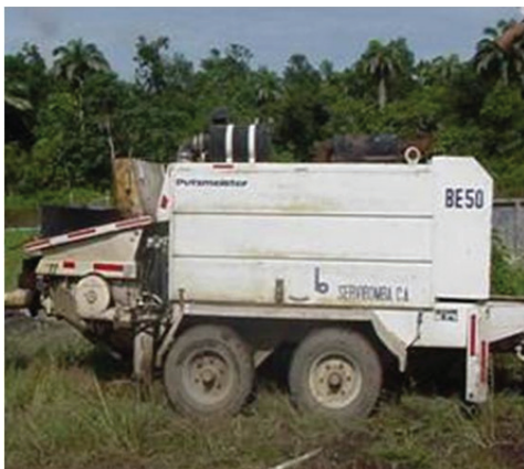
FIG.15 Bomba de pistón de 600 psi utilizada para inyectar materiales en bulbos de gran tamaño.
