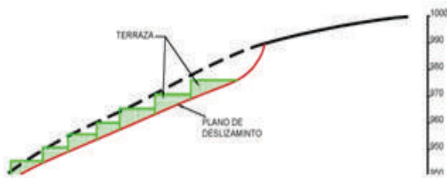
Figura N° 10 Perfil topográfico que muestra el plano de deslizamiento y la construcción de terrazas de cultivo
