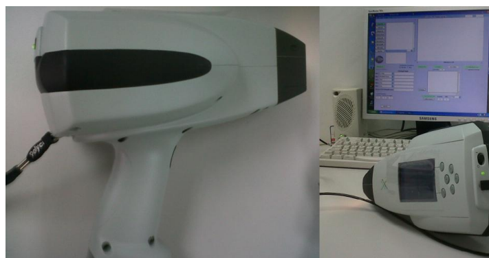
Figura 3: Equipo Polychromix, Modelo Phazir para análisis NIR utilizado para la realización de los espectros tanto de las muestras sólidas como las líquidas.
