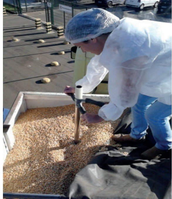
Figura 1. Coleta de amostras de milho grão utilizando calador específico para cargas a granel em fábrica de ração. Fonte: Arquivo pessoal, (2014).
