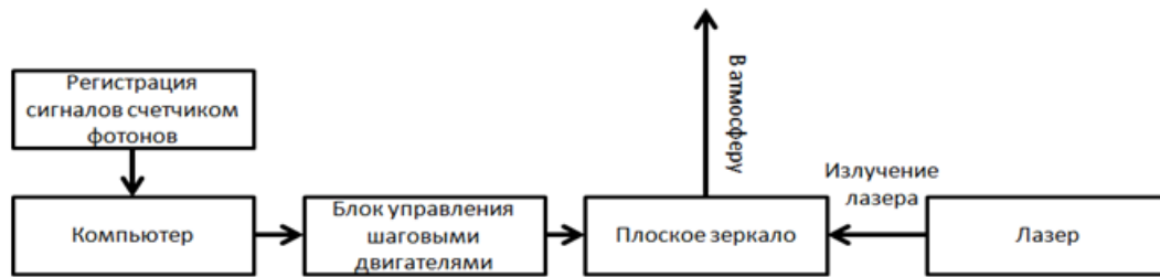
Рис. 3. Структурная схема автоматизированного узла юстировки оптических осей приемо-передающего тракта лидара
