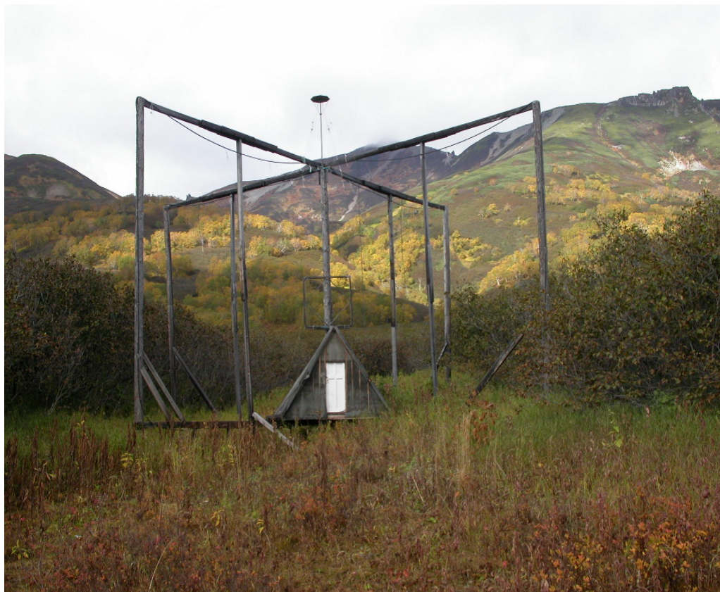
Рис. 3. Антенная система для регистрации радиосигналов в ОНЧ диапазоне, установленная в пункте наблюдения «Карымшина»
