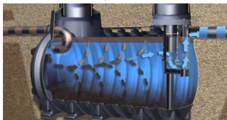
c) Sludge layer deposit
