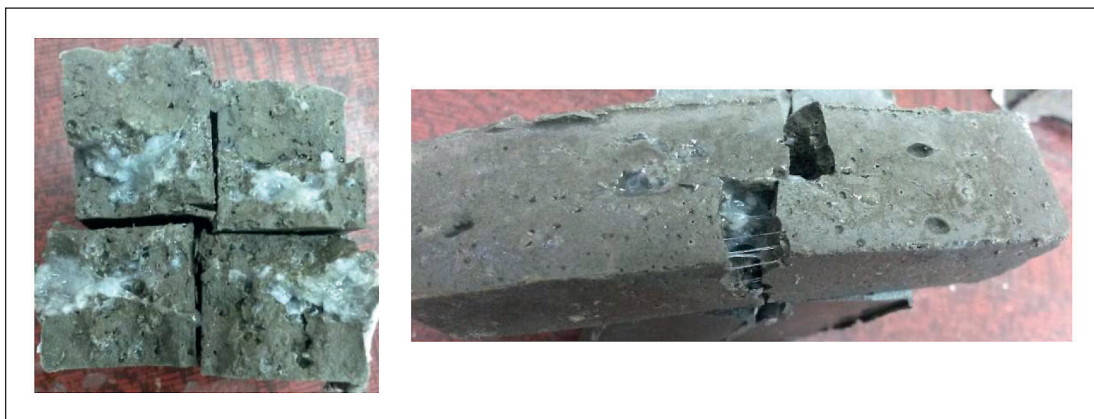
Рис. 2. Образцы камня с добавкой ПАА (1%) после испытания на изгиб
