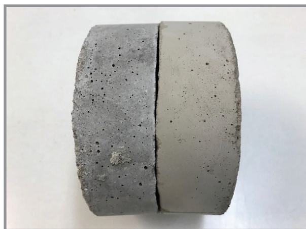
Рис. 2. Образцы-цилиндры ЦПР (слева – без воздействия, справа – после воздействия СВЧ ЭМИ в течение 2 мин.)
