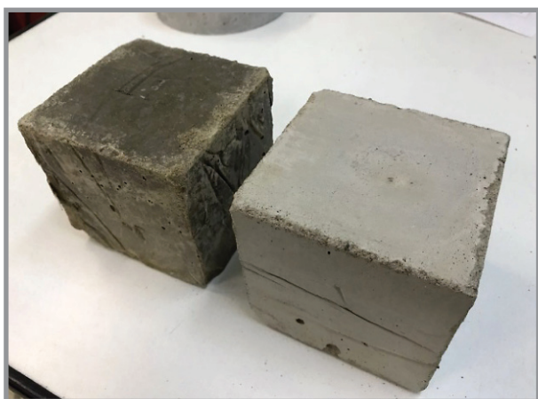
Рис. 1. Образцы-кубы ЦПР (слева – без воздействия, справа – после воздействия СВЧ ЭМИ в течение 2 мин.)
