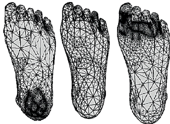
Figura 4. Mallado del modelo, de izquierda a derecha: apoyo de talón, transferencia de carga y despegue de talón.
