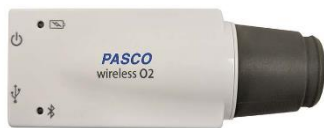
Figura 3. Sensores para la medición de la concentración de oxígeno en el aire y algunas de sus características.
