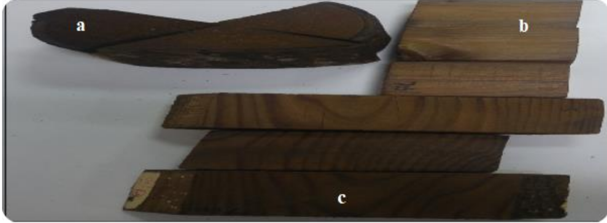
Şekil 9. Kesit yönleri (a) enine, (b) radyal ve (c) teğet olarak alınmış masif odunların yapay yaşlandırma sonrası renk değişimleri.
