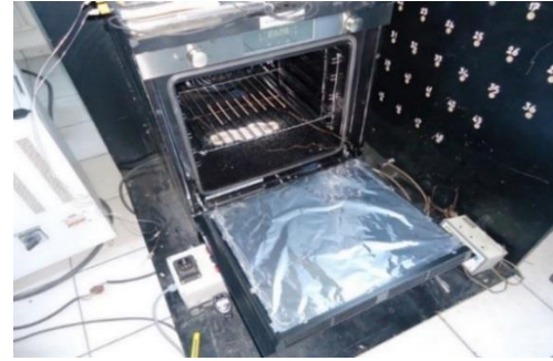
Şekil 5: İç camı alüminyum tabaka ile kaplanmış fırın test düzeneği.
