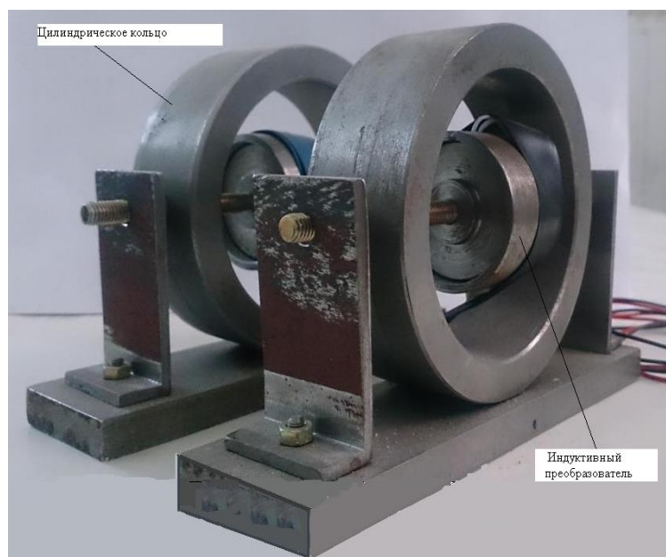
Рисунок 2 - Датчик усилия с чувствительным цилиндрическим элементом для фиксирования нагрузок от штанги глубинного насоса в бурильной установке.
