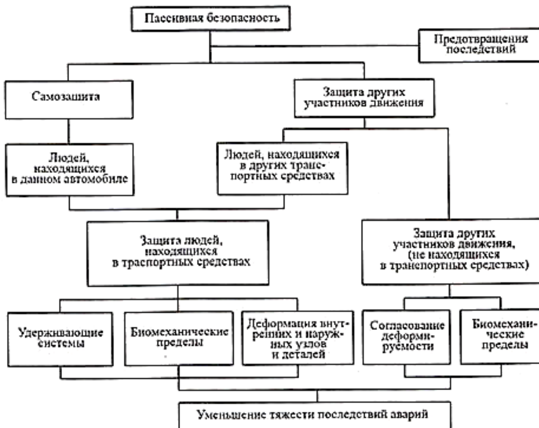
Рисунок 2 - Структурная схема пассивной безопасности автомобиля.
