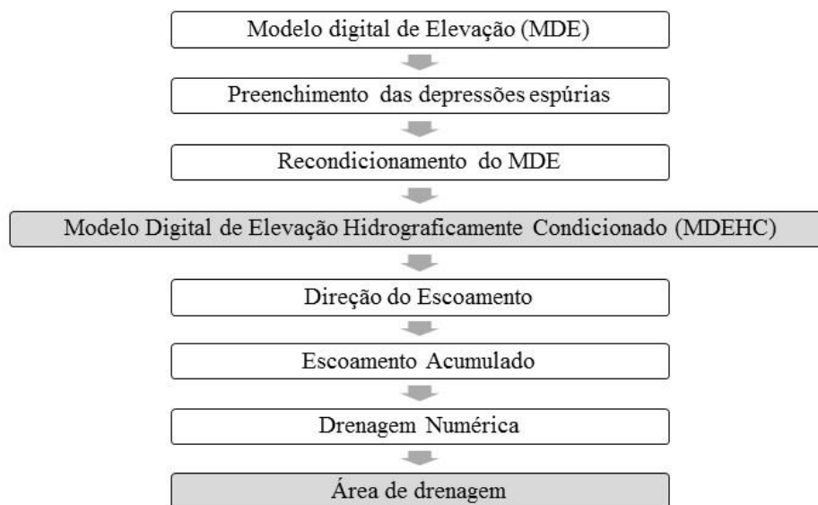
Figura 3. Organograma indicativo dos processos utilizados para o recondicionamento do MDE e determinação da área de drenagem no software ArcGIS por meio da extensão ArcHydro.
