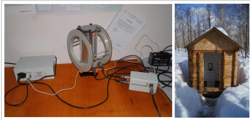
Рис. 1. Векторный магнитометр POS-4. На левой панели: слева – источник бесперебойного питания, в центре – датчик (соленоид и колечная система на трегере), справа – электронный блок. На правой панели: павильон POS-4 – датчик магнитометра установлен на постаменте из стеклоблоков, дверь в павильон съемная, на латунных болтах (март 2016 г.)
