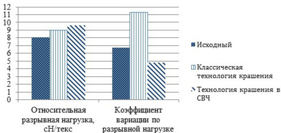
Рисунок 4 – Относительная разрывная нагрузка и коэффициент вариации по разрывной нагрузке шерстяной пряжи
