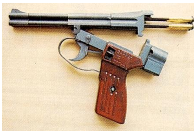
Рис. 4. Пистолет СПП-1 в положении для снаряжения патронами.
