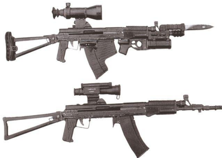
Рис. 7. Автомат АСМ-ДТ с магазином для подводной (вверху) и наземной стрельбы.
