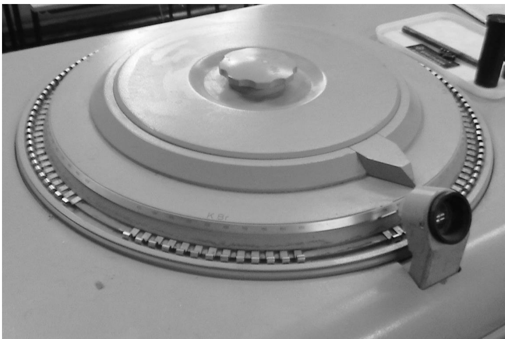
Рис. 5. Программирующее устройство на верхней крышке прибора
