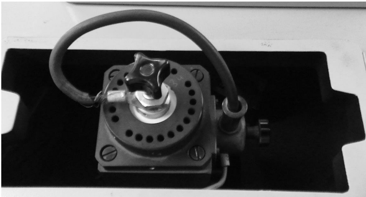
Рис. 4. Эргономичный винтовой контакт, позволяющий встраивать в электрическую цепь прибора дополнительные звенья
