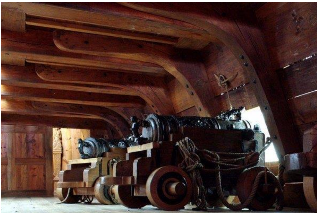
Рис. 4. Орудийный порт и пушка шведского корабля «Ваза»
